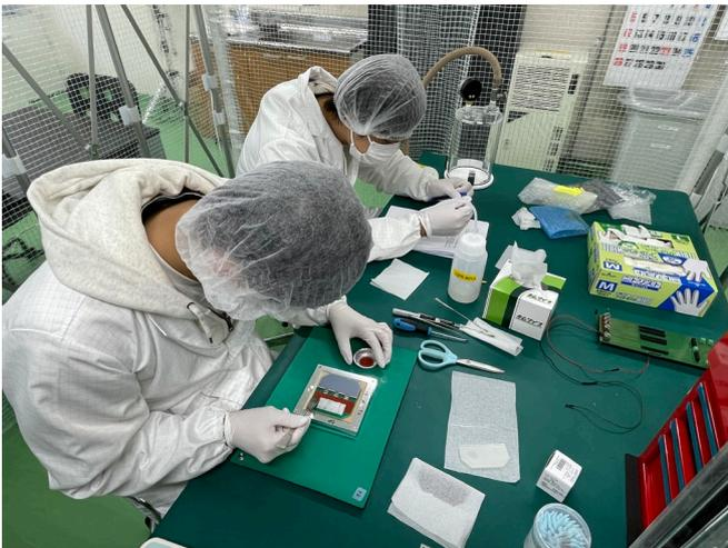
図 2 FM 太陽光パネル接着作業
