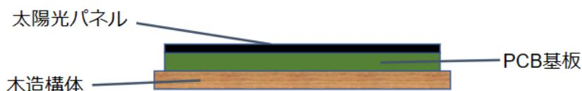
図1 LignoSat 独自の太陽光パネル接着方法模式図
