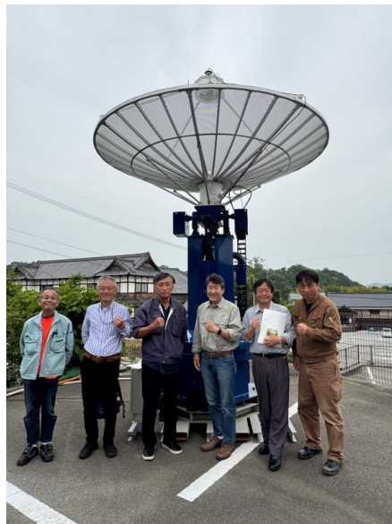
写真 直径 3m のパラボラアンテナ
