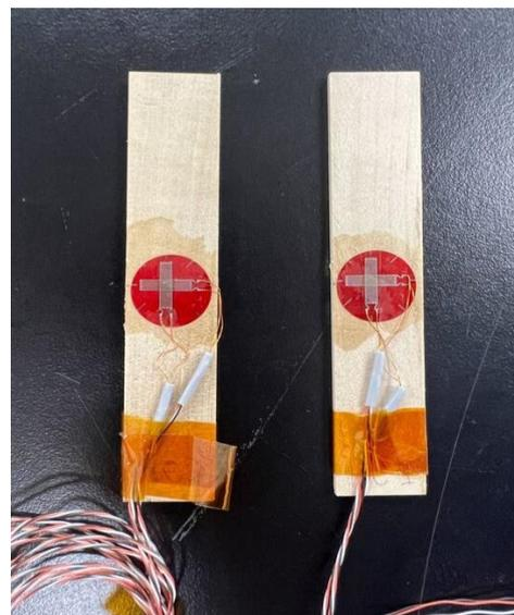
図 1 ひずみゲージ貼り付け試料
