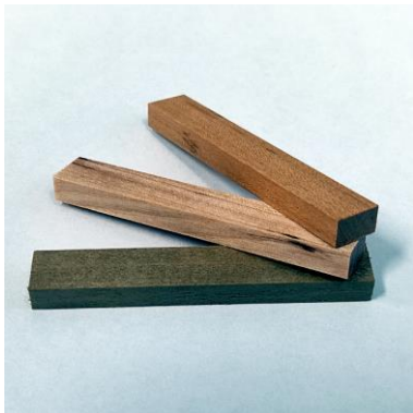
図 1 曝露試験に供した木材 （上からヤマザクラ、ダケカンバ、 ホオノキ） ©京都大学
