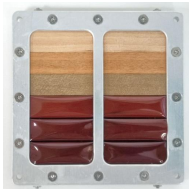
図 2 宇宙曝露試験体 ©京都大学、©Space BD
