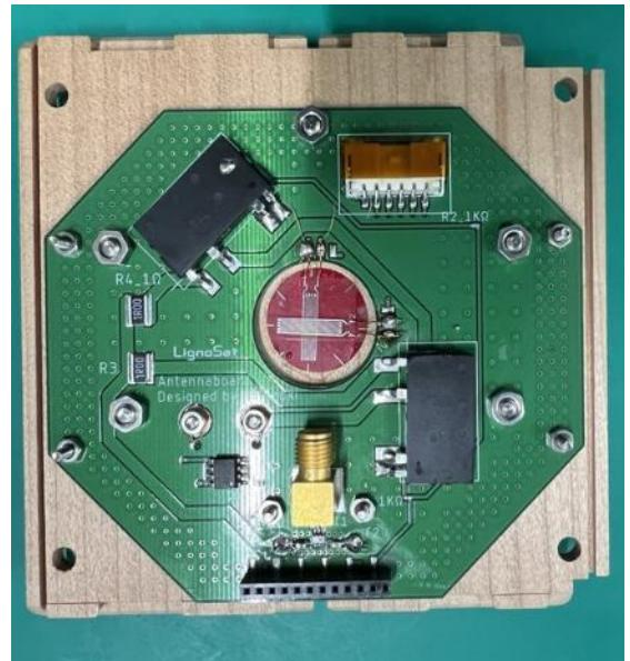
図4 LignoSat のひずみゲージ貼り付け面
