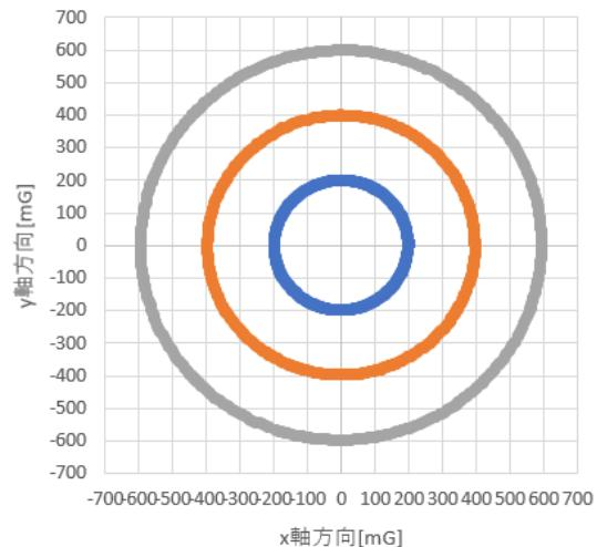
図 9 XY 平面上で回転させた時の磁気測定結果
