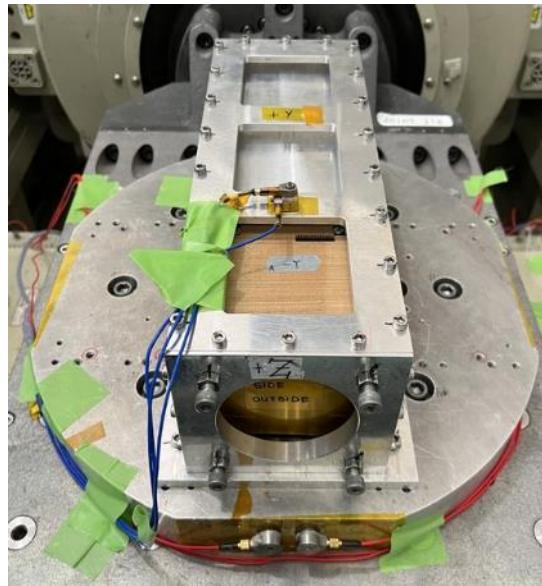
図 5 ひずみゲージ振動試験の様子
