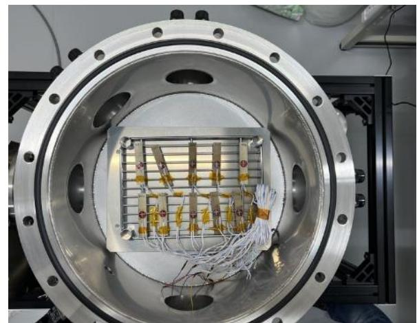
図 2 高真空中曝露の様子
