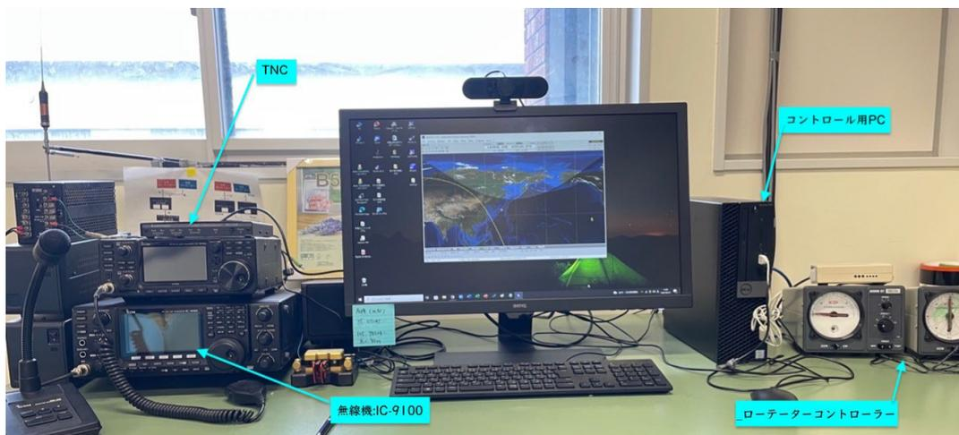
LignoSat のコントロールのための地球局の設備の詳細
