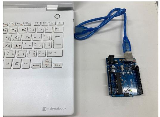
図 3 Arduino と PC の接続
