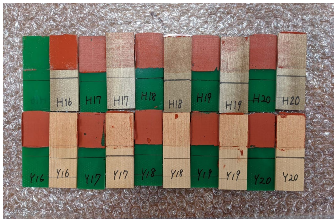
図1 せん断後の試験体
